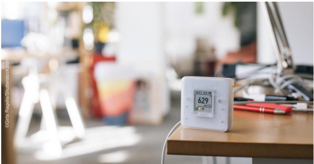
Installer des appareils de mesure du CO<sub>2</sub> dans une pièce permet de surveiller la qualité de l'air intérieur et d'intervenir rapidement si nécessaire. Pour garantir leur bon fonctionnement, le choix et l'installation de ces appareils sont réglementés.
